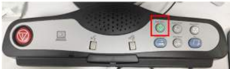
Рисунок 1. На интерфейсном модуле управления сканированием (SCIM) горит лампа в кнопке Start Scan (Запуск сканирования).
