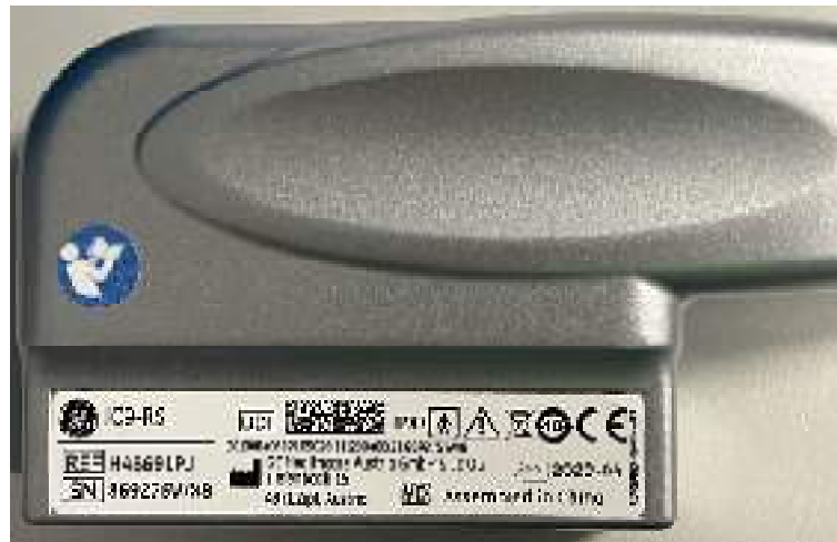
Рисунок 4. Пример таблички с указанием типа датчика (IC9-RS) и серийного номера (SN).
