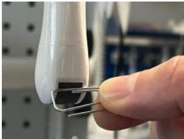
Рисунок 1: Процедура проверки двойного изображения. Поместите металлический отражатель (показана скрепка) на краю поля зрения. Проведите отражателем по всей кривизне датчика.
