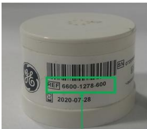
Рисунок 5: Номер по каталогу датчика кислорода: 6600-1278-600 Рисунок 6: Номер по каталогу датчика кислорода: M-43GE
